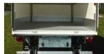
Aménagements lavable (plancher alu polyuréa, plinthes alu, bonde évacuation, ventilation)
